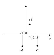
$$\begin{split} H\left(e^{j\omega}\right) &= \sum_{n=-\infty}^{\infty} h\left(n\right) e^{-j\omega n} \\ &= h\left(-1\right) e^{-j\omega(-1)} + h\left(1\right) e^{-j\omega(1)} + h\left(3\right) e^{-j\omega(3)} \\ &= -e^{j\omega} + e^{-j\omega} - e^{-3j\omega} \end{split}$$
